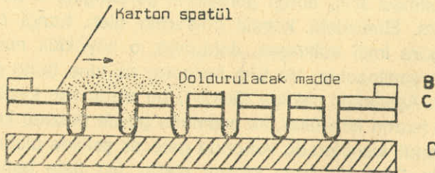
Şekil-2. Sert jelatin kapsül doldurma ve kapatma aletine etken madde ve yardımcı maddelerden oluşan karışımın doldurulması.
